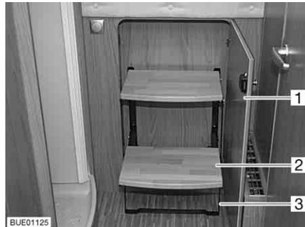
Bild 87 Trittstufe, ausgeklappt
