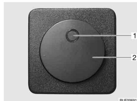
Bild 142 Schalter für elektrische Fußbodenerwärmung
