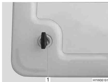
Bild 35 Druckschloss Serviceklappe
