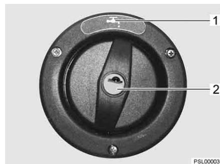
Bild 38 Verschlussdeckel für Trinkwasser-Einfüllstutzen (Alternative)
