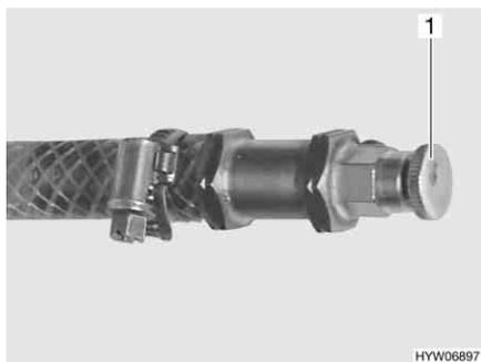
Bild 197 Entlüftungsventil Warmwasser-Heizung
