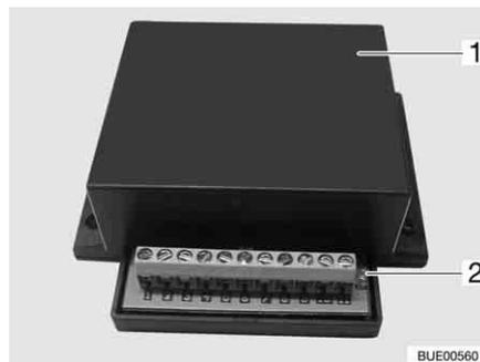
Bild 104 Gassensor
