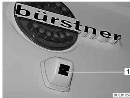
Bild 16 Rückfahrkamera (Beispiel)
