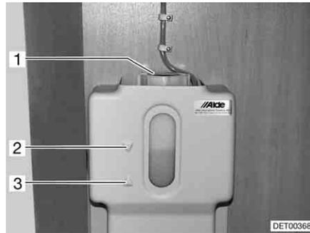
Bild 196 Ausgleichsbehälter Warmwasser-Heizung
