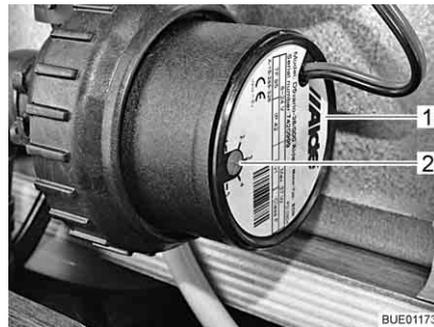
Bild 135 Drehzahlreduzierung
