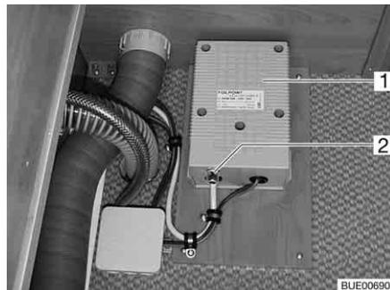
Bild 141 Trafo für elektrische Fußbodenerwärmung
