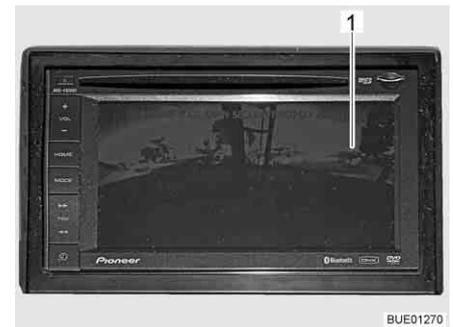
Bild 17 LCD-Monitor für Rückfahrkamera (Beispiel)
