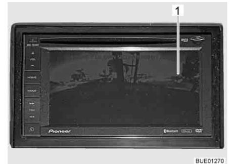
Fig. 17 Monitor LCD para la cámara de marcha atrás (ejemplo)
