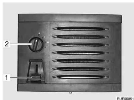
Fig. 140 Elementos de mando termocambiador adicional
