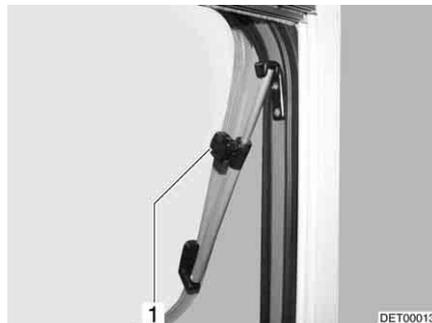
Fig. 57 Ventana abatible con soportes giratorios, abierta
