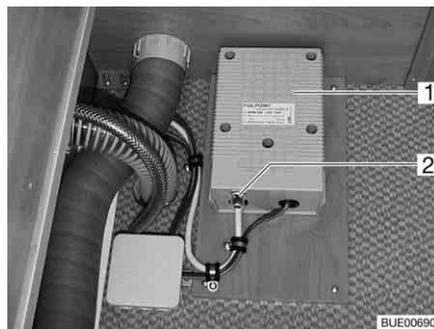
Fig. 141 Transformador para calentamiento eléctrico del piso
