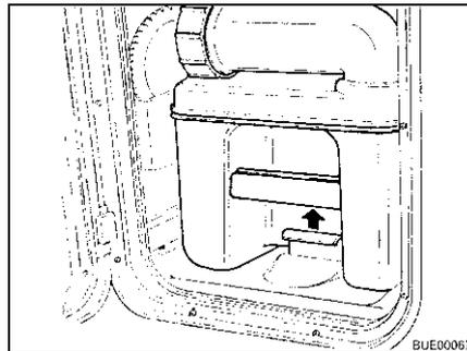
Fig. 178 Tirar del estribo de sujeción
