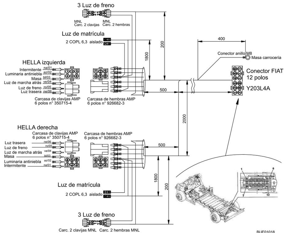
Fig. 129 Esquema de circuitos exterior
