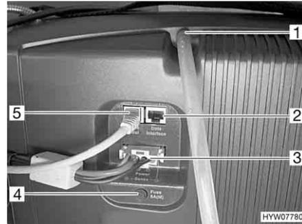
Fig. 110 Campo de conexiones de la pila de combustión
