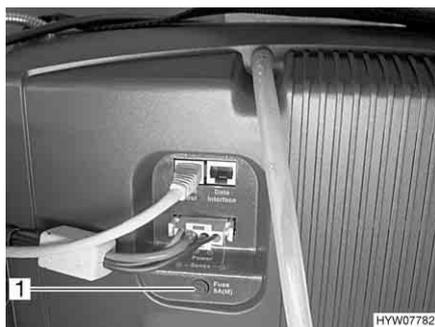
Fig. 119 Fusible de la pila de combustión
