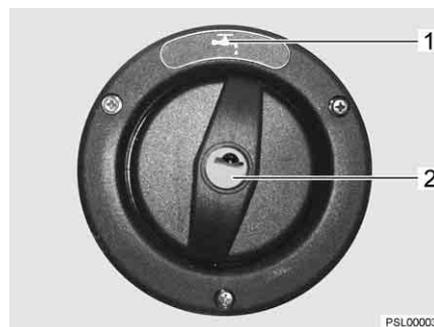
Fig. 169 Tapa de cierre para el tubo de llenado de agua potable (alternativa)
