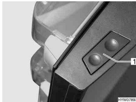
Fig. 164 Botón de desbloqueo de la puerta del frigorífico (Dometic de la serie 8)
