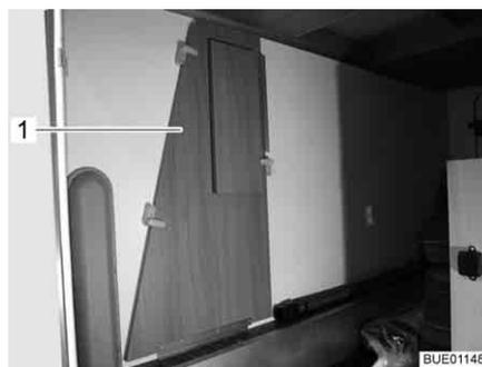
Fig. 12 Ensanchamiento de cama en el garaje trasero
