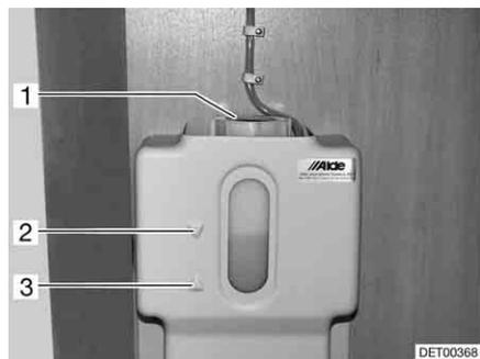
Fig. 196 Recipiente de compensación para la calefacción de agua caliente
