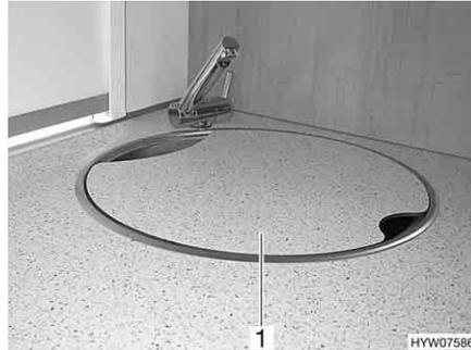
Fig. 11 Cubierta del fregadero
