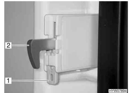
Fig. 165 Fijación del gancho de bloqueo
