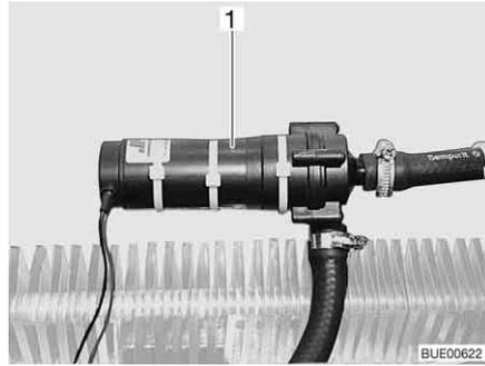
Fig. 138 Bomba de circulación adicional
