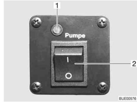
Fig. 139 Conmutador de mando de la bomba de circulación adicional
