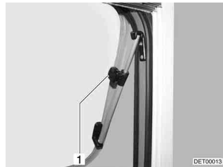
Kuva 73 Kattoluukku, jossa on kääntöpidikkeet, avattu
