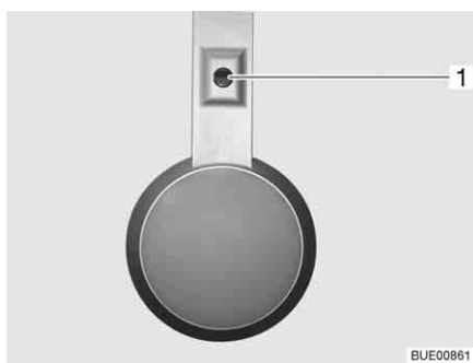
Kuva 45 WC-tilan valaisin, valokatkaisija suoraan valaisimessa
