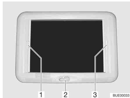
Kuva 71 Kammella nostettava kattoluukku
