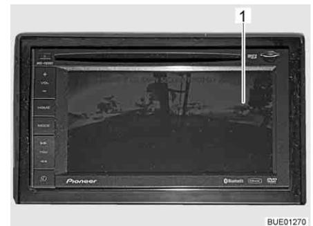
Bild 17 LCD-Monitor für Rückfahrkamera (Beispiel)
