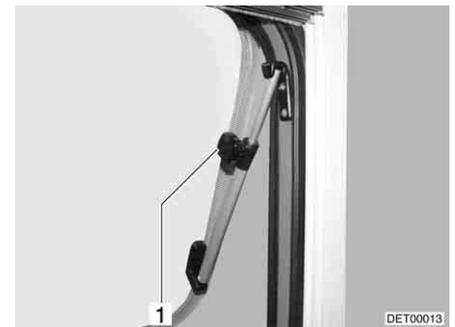
Bild 73 Dachhaube mit Dreh-Ausstellern, geöffnet
