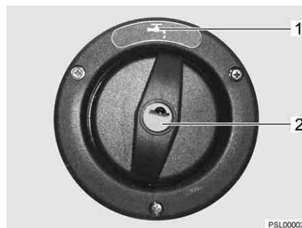
Bild 220 Verschlussdeckel für Trinkwasser-Einfüllstutzen (Alternative)
