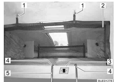
Bild 95 Hubbett mit aufgespanntem Sicherungsnetz
