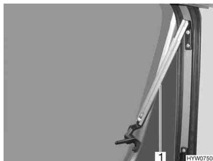
Bild 60 Ausstellfenster mit Automatik-Ausstellern, geöffnet
