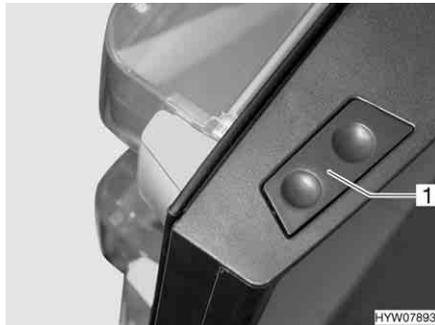
Bild 215 Entriegelungstaste der Kühlschranktür (Dometic 8er-Reihe)
