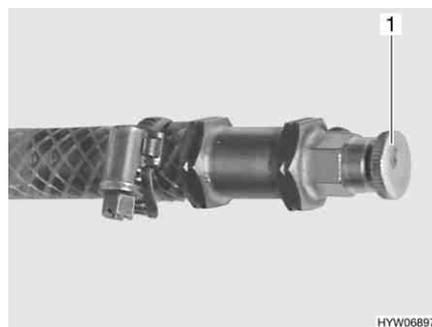
Bild 268 Entlüftungsventil Warmwasser-Heizung
