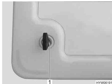
Bild 36 Druckschloss Serviceklappe
