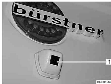
Bild 16 Rückfahrkamera (Beispiel)
