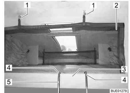
Bild 99 Hubbett mit aufgespanntem Sicherungsnetz
