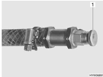
Fig. 268 Válvula de purga de la calefacción de agua caliente
