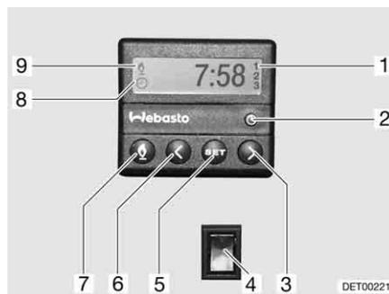
Fig. 188 Unidad de mando para la calefacción auxiliar
