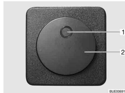
Fig. 187 Interruptor para calentamiento eléctrico del piso
