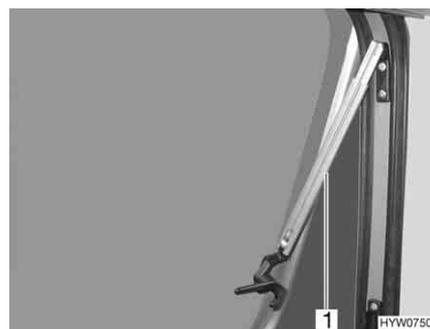
Fig. 60 Ventana abatible con soportes automáticos, abierta
