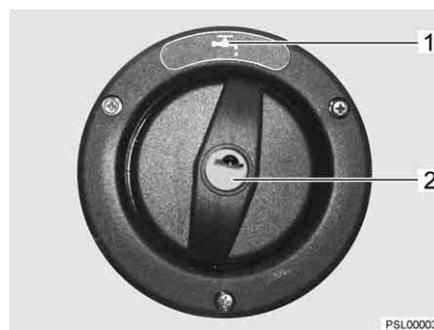
Fig. 220 Tapa de cierre para el tubo de llenado de agua potable (alternativa)
