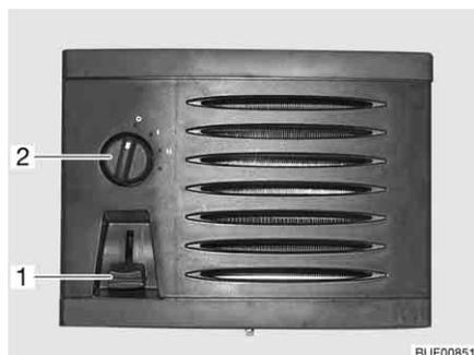
Fig. 185 Elementos de mando termocambiador adicional
