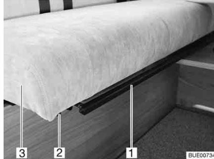
Fig. 20 Ajuste del respaldo del banco
