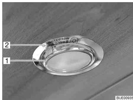
Fig. 275 Lámpara halógena empotrada (plana)
