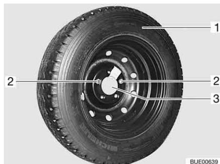
Fig. 284 Etrier de roue de secours dans le garage arrière
