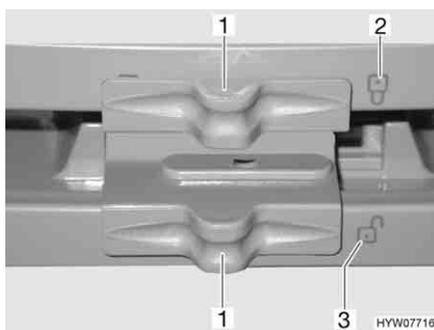
Fig. 213 Verrouillage de la porte du réfrigérateur/du compartiment congélation (Dometic Série 7 avec compartiment congélation séparé)
