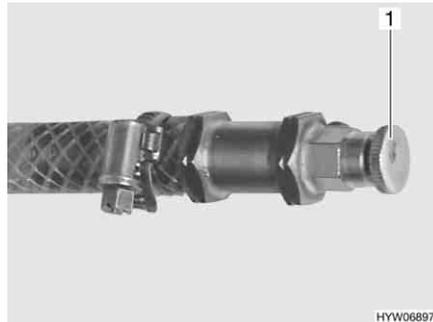
Fig. 268 Soupape de purge pour le chauffage à eau chaude
