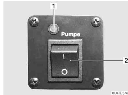
Fig. 184 Commutateur de commande du circulateur supplémentaire
