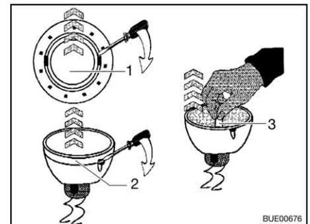
Fig. 274 Remplacer l'ampoule halogène
