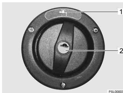
Fig. 39 Couvercle de fermeture pour bec de remplissage d'eau potable (alternative)
