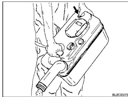
Fig. 264 Vidanger le réservoir pour matières fécales
