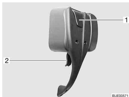
Fig. 30 Serrure de la porte cellule, à l'intérieur, verrouillée
