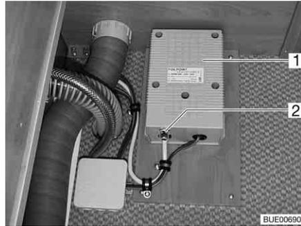
Fig. 186 Transformateur du chauffage électrique du plancher
