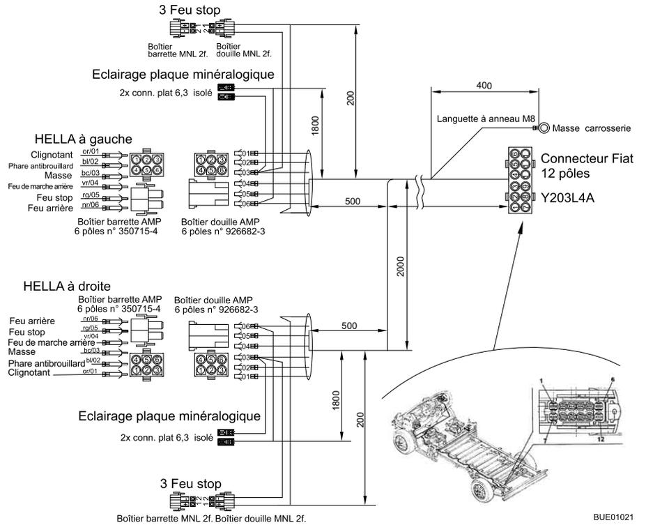
Fig. 174 Schéma électrique extérieur
