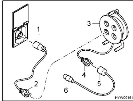
Fig. 157 Possibilités de raccordement 230 V
