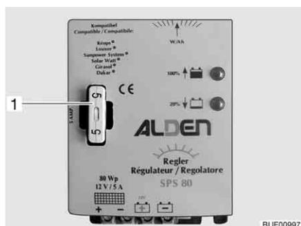
Fig. 166 Fusible régulateur de panneau solaire
