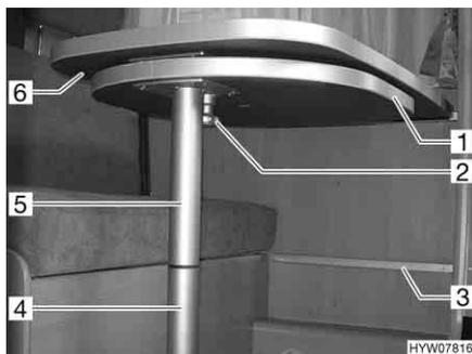
Fig. 76 Table suspendue avec pied d'appui divisible
