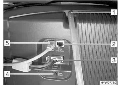
Fig. 154 Champ de raccordement de la pile à combustible
