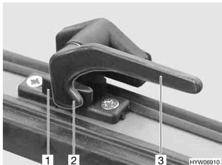
Fig. 72 Levier de verrouillage en position "Fermé"
