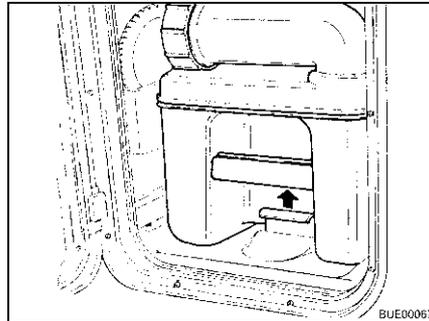
Fig. 245 Tirer l'étrier de fixation
