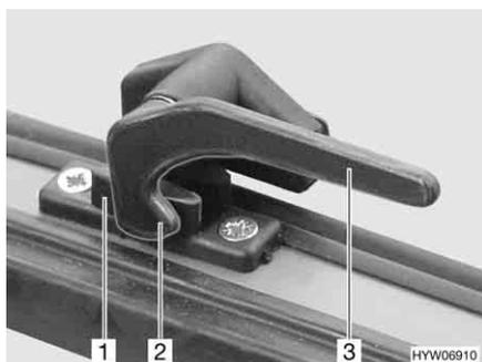
Fig. 59 Levier de verrouillage en position "Fermé"
