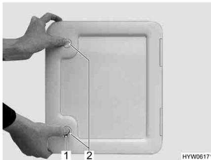
Fig. 258 Portillon pour le réservoir pour matières fécales
