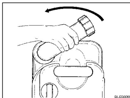
Fig. 247 Tourner la tubulure d'évacuation
