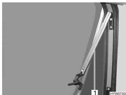
Fig. 60 Fenêtre projetante avec bras automatiques, ouverte
