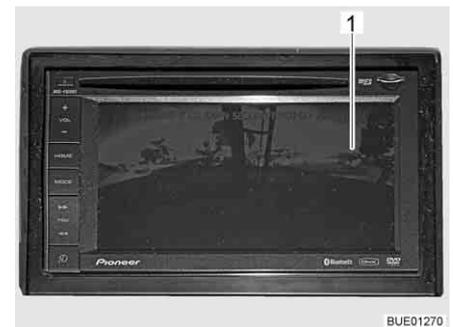
Fig. 17 Moniteur ACL pour caméra de marche arrière (exemple)
