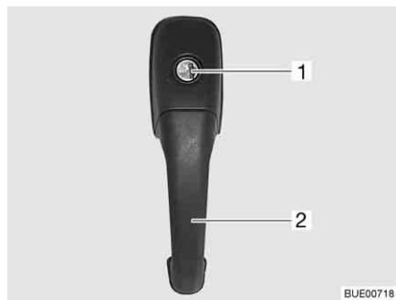
Kuva 39 Sisäänkäyntioven lukko, ulkoa
