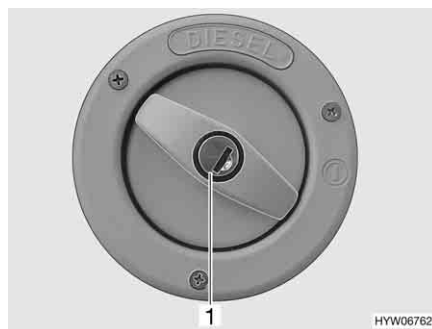
Kuva 31 Polttoainesäiliön täyttöaukon korkki
