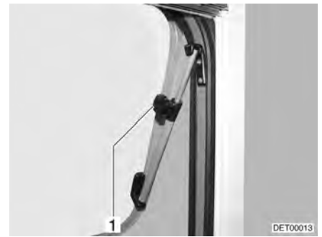
Billede 55 Ventilationsrude med drejeudskydere, åben
