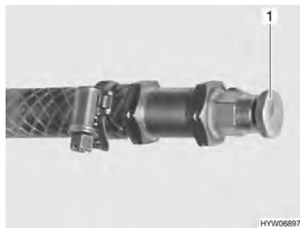
Billede 197 Udluftningsventil varmtvandsvarmeovn
