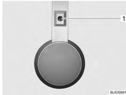
Fig. 44 Éclairage du cabinet de toilette, interrupteur d'éclairage directement sur la lampe
