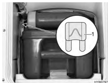
Fig. 114 Fusible des toilettes Thetford
