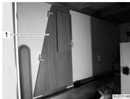
Fig. 12 Rallonge latérale de lit dans le garage arrière
