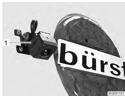
Fig. 16 Caméra de marche arrière
