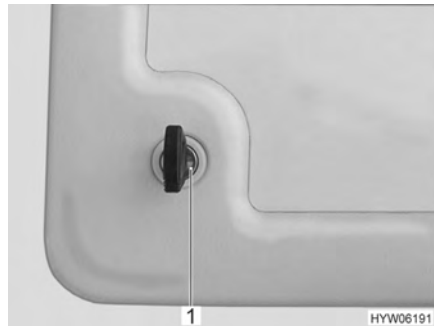
Fig. 32 Verrou de pression portillon de service
