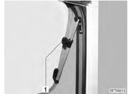
Fig. 70 Lanterneau avec bras pivotants, ouvert
