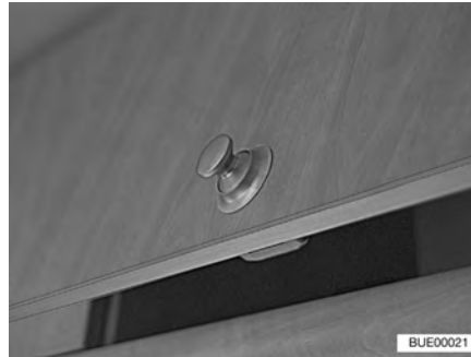
Fig. 36 Abattant de placard avec bouton-poussoir
