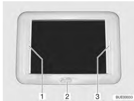
Fig. 68 Lanterneau à manivelle
