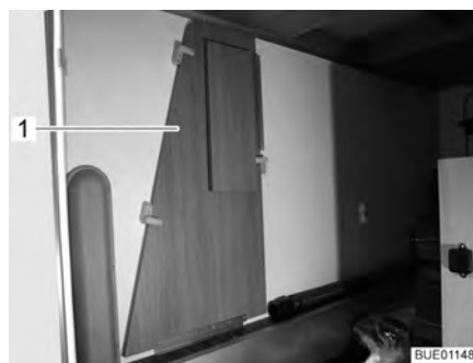
Fig. 12 Ensanchamiento de cama en el garaje trasero
