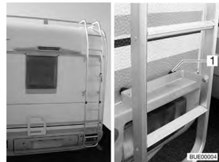
Fig. 2 Escalera plegada hacia abajo
