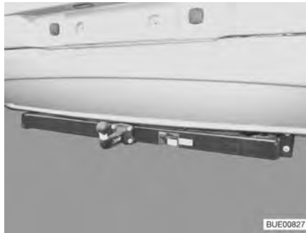
Fig. 6 Acoplamiento de remolque
