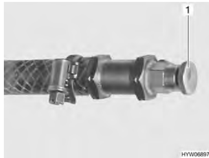
Fig. 197 Válvula de purga de la calefacción de agua caliente
