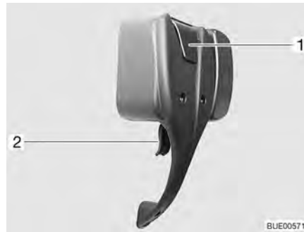
Kuva 37 Sisäänkäyntioven lukko, sisällä, lukittu
