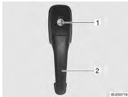
Kuva 36 Sisäänkäyntioven lukko, ulkoa
