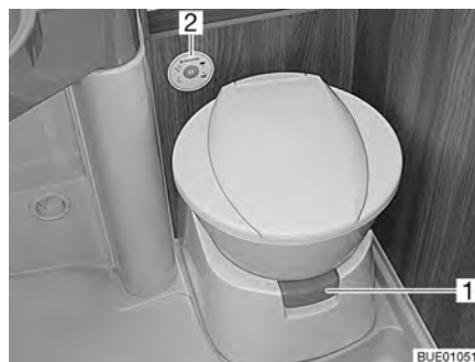
Kuva 218 WC-istuin ja valvonta- ja säätöyksikkö
