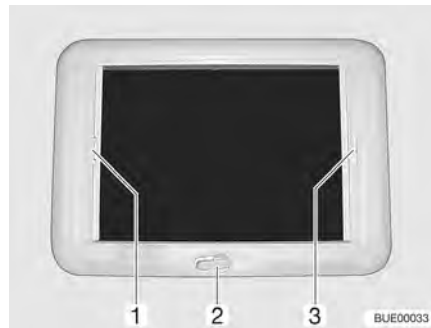
Kuva 80 Kammella nostettava kattoluukku
