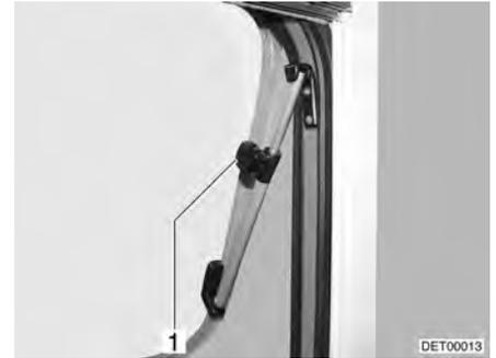
Bild 64 Ausstellfenster mit Dreh-Ausstellern, geöffnet
