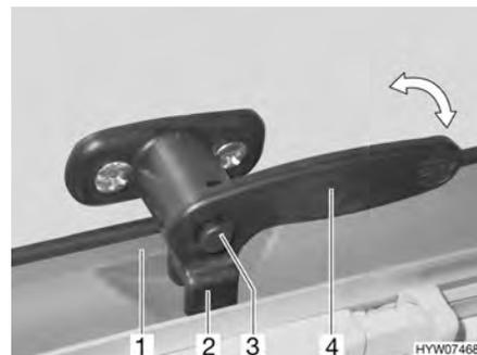
Bild 69 Verriegelungshebel mit Sicherungsknopf in Stellung "geschlossen"
