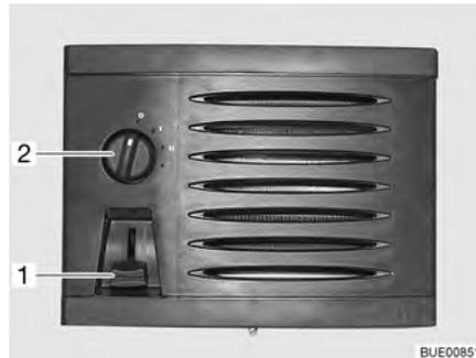
Bild 143 Bedienelemente Zusatz-Wärmetauscher
