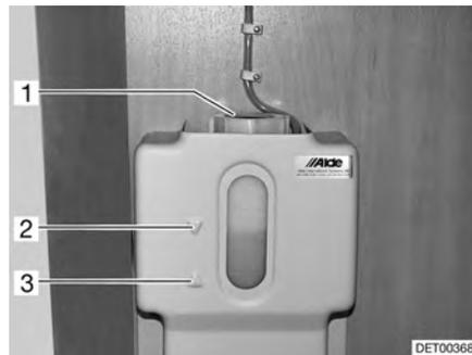
Bild 222 Ausgleichsbehälter Warmwasser-Heizung
