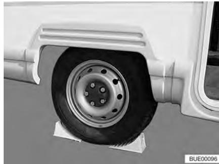
Bild 247 Fahrzeug sichern
