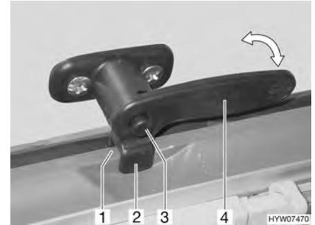
Bild 71 Verriegelungshebel mit Sicherungsknopf in Stellung "Dauerbelüftung"
