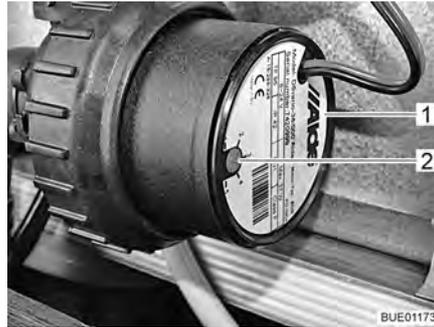
Bild 138 Drehzahlreduzierung
