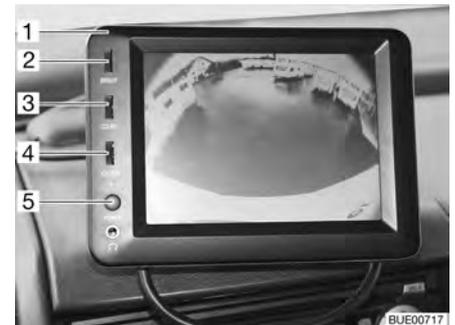
Bild 12 LCD-Monitor für Rückfahrkamera
