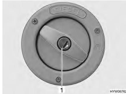
Bild 30 Verschlussdeckel für Kraftstoff-Einfüllstutzen
