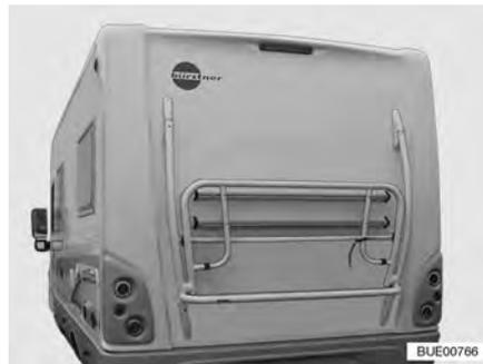
Bild 2 Fahrradträger, nicht absenkbar
