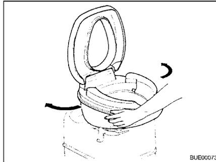
Bild 191 Toilettenschüssel drehen
