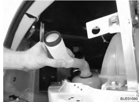
Bild 29 Einfüllstutzen in Füllposition
