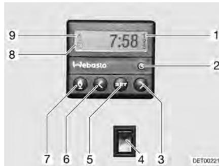
Bild 146 Bedieneinheit für Standheizung
