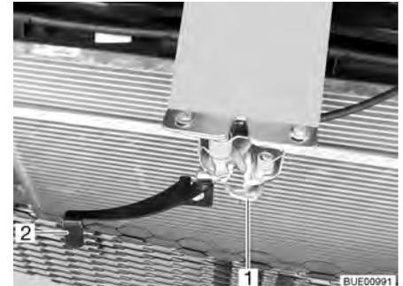
Bild 26 Entriegelungshebel Motorhaube (außen)
