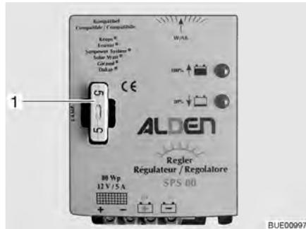
Bild 121 Sicherung Solar-Laderegler
