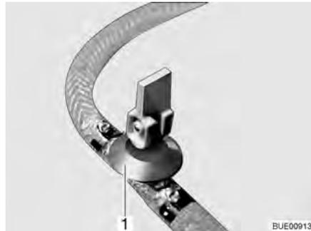
Fig. 181 Llave de desagüe (con balancín)
