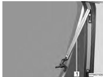
Fig. 67 Ventana abatible con soporte automático
