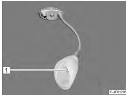
Fig. 240 Foco halógeno (cuello de cisne)
