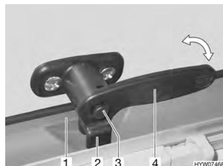
Fig. 69 La palanca de bloqueo con botón de seguridad en la posición "cerrada"
