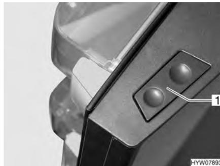
Fig. 171 Botón de desbloqueo de la puerta del frigorífico (Dometic de la serie 8)
