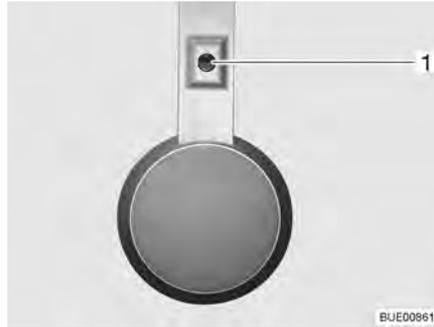
Fig. 52 Luz del cuarto de aseo, interruptor de luz directamente en la lámpara
