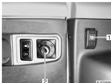
Fig. 21 Interruptor de ajuste de los retrovisores exteriores y de la calefacción de los retrovisores exteriores
