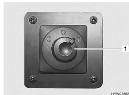
Fig. 22 Interruptor de ajuste de los retrovisores exteriores
