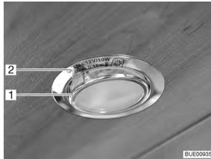
Fig. 236 Lámpara halógena empotrada (plana)
