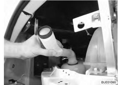
Fig. 29 Tubo de llenado en posición de llenado
