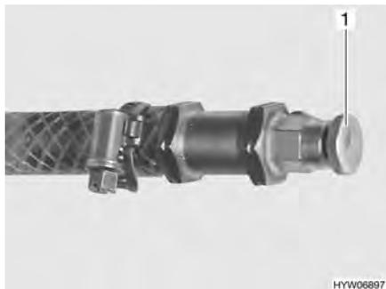
Fig. 223 Válvula de purga de la calefacción de agua caliente
