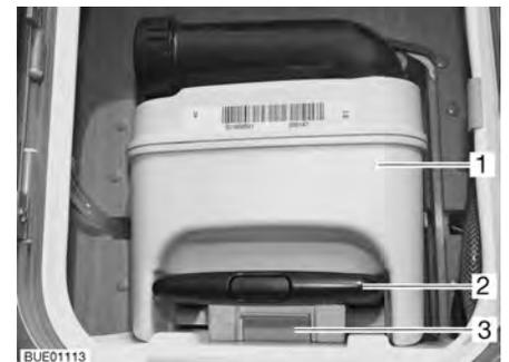
Fig. 215 Depósito de aguas fecales
