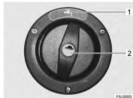
Fig. 47 Tapa de cierre para el tubo de llenado de agua potable (alternativa)
