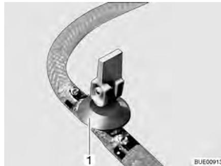
Fig. 183 Llave de desagüe (con balancín)
