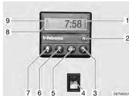
Fig. 146 Unidad de mando para la calefacción auxiliar
