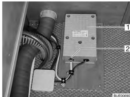
Fig. 144 Transformador para calentamiento eléctrico del piso
