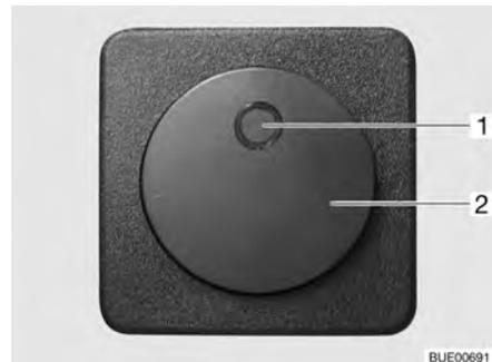
Fig. 145 Interruptor para calentamiento eléctrico del piso
