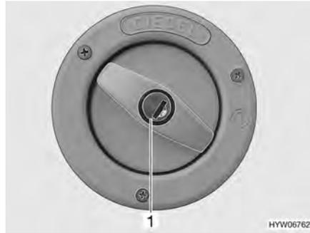
Fig. 30 Tapa de cierre para el tubo de llenado de combustible
