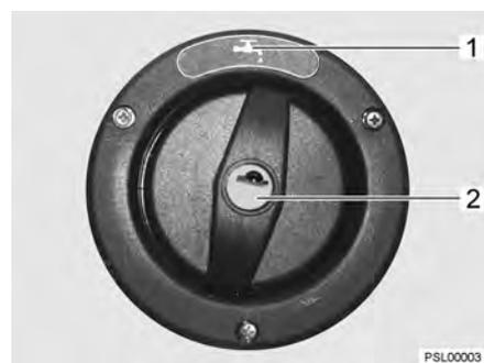
Fig. 176 Tapa de cierre para el tubo de llenado de agua potable (alternativa)
