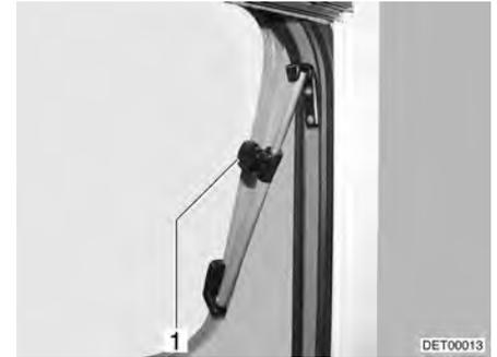
Fig. 64 Ventana abatible con soportes giratorios, abierta
