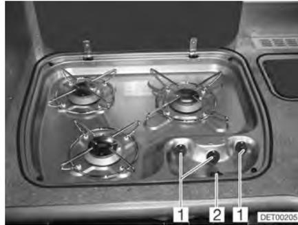
Fig. 157 Elementos de mando para la cocina de gas
