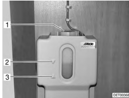
Billede 222 Udligningsbeholder varmtvandsvarmeovn
