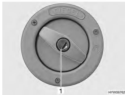
Billede 30 Dæksel til brændstof-påfyldningsstudsene
