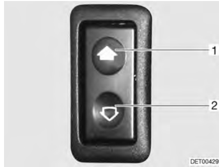
Billede 19 Kontakt til elektriske vinduesåbnere
