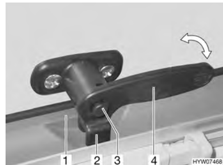
Billede 69 Låsehåndtag med sikringsknop i stilling "lukket"
