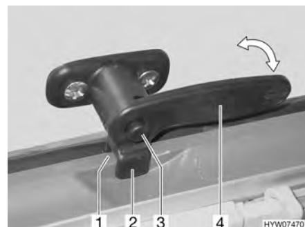
Billede 71 Låsehåndtag med sikringsknop i stilling "permanent ventilation"
