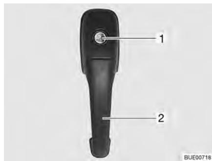
Billede 36 Indgangsdørens dørlås, udvendigt
