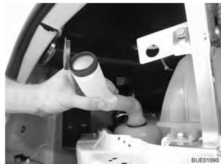
Fig. 29 Bocchettone di riempimento in posizione di riempimento
