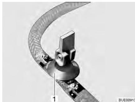
Fig. 183 Rubinetto di scarico (con leva a bilancere)
