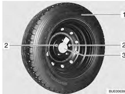
Fig. 248 Supporto per la ruota di scorta nel garage di coda
