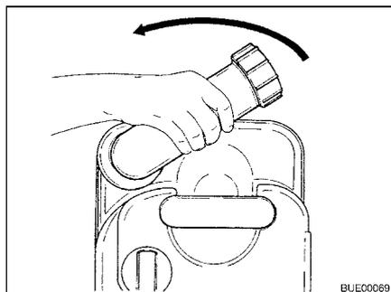
Fig. 187 Ruotare il bocchettone di scarico
