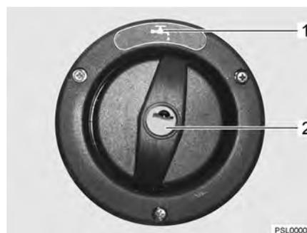
Fig. 176 Coperchio per bocchettone di riempimento dell'acqua potabile (alternativa)
