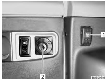
Fig. 21 Interruttore regolazione degli specchietti esterni e riscaldamento degli specchietti esterni
