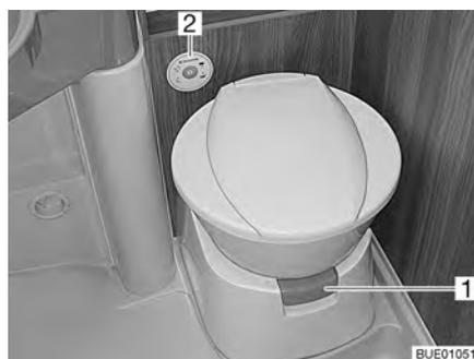
Fig. 218 Tazza del WC con centralina di controllo e di comando
