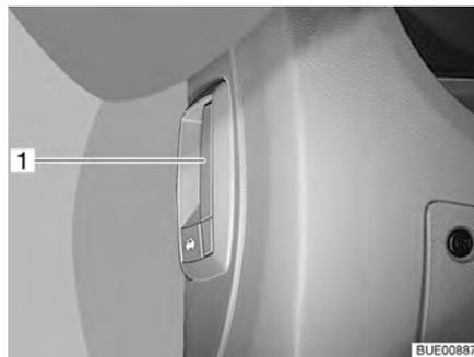
Fig. 25 Leva di sbloccaggio cofano motore (nel veicolo)
