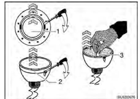
Fig. 235 Sostituire la lampada alogena ad incandescenza
