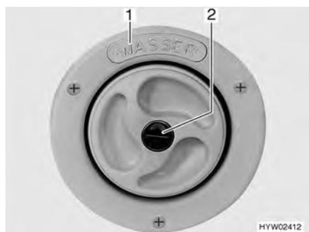
Fig. 175 Coperchio per bocchettone di riempimento dell'acqua potabile
