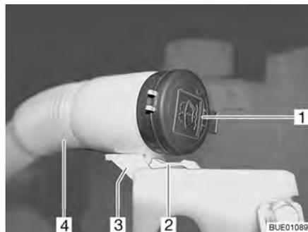
Fig. 28 Bocchettone di riempimento del contenitore dell'acqua di lavaggio
