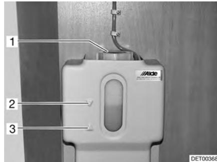
Fig. 222 Vaso d'espansione del riscaldamento ad acqua calda
