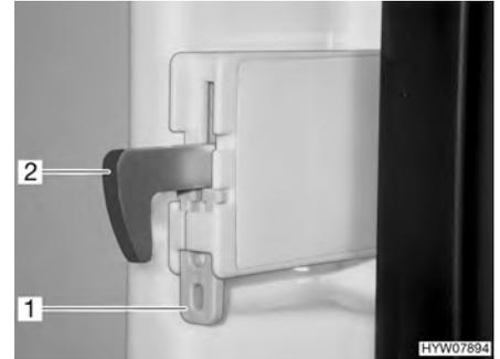
Fig. 172 Fissaggio del gancio di bloccaggio
