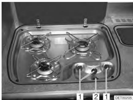
Fig. 157 Elementi di comando del fornello a gas
