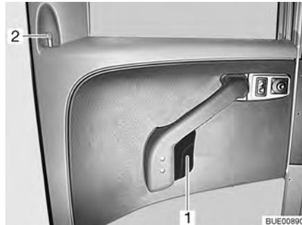
Fig. 35 Serratura della porta conducente, lato interno
