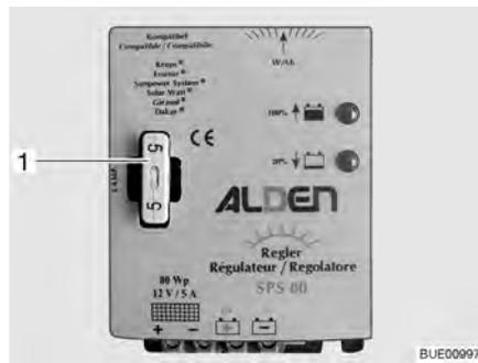
Fig. 121 Fusibile regolatore di carica del pannello solare
