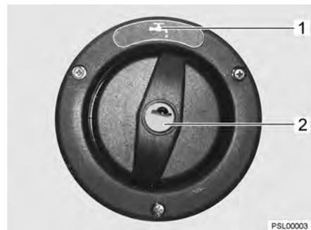
Fig. 47 Coperchio per bocchettone di riempimento dell'acqua potabile (alternativa)
