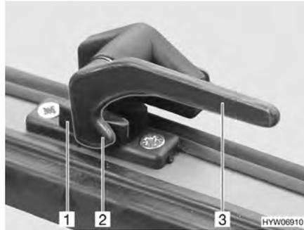
Fig. 63 Leva di serraggio in posizione "Chiuso"
