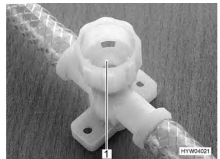
Fig. 184 Rubinetto di scarico (con tappo a vite)
