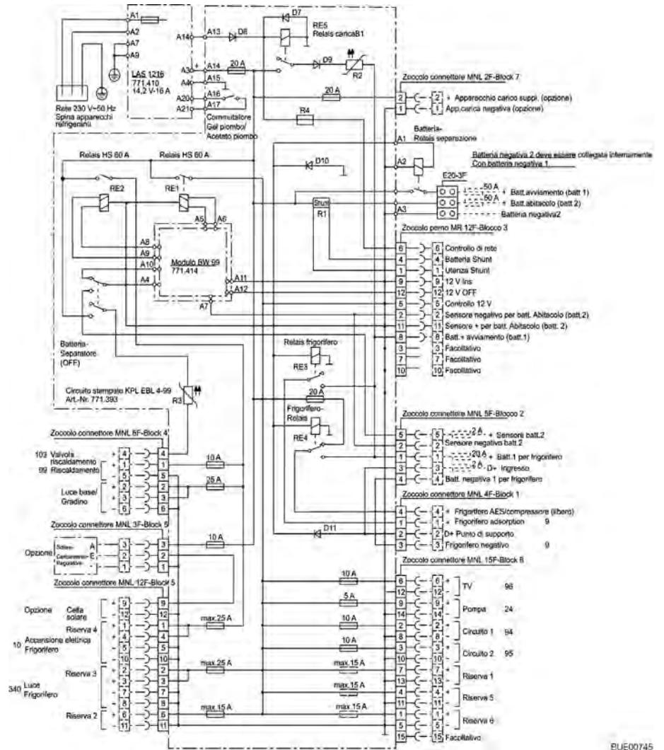
Fig. 127 Schema elettrico interno (EBL 99)
