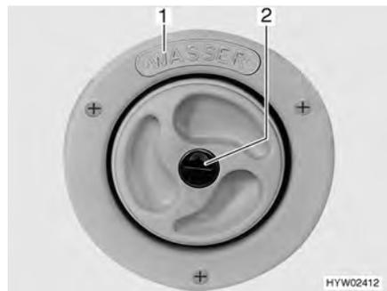
Fig. 46 Coperchio per bocchettone di riempimento dell'acqua potabile
