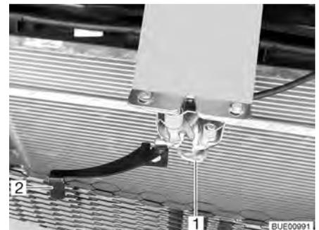
Fig. 26 Leva di sbloccaggio cofano motore (all'esterno)
