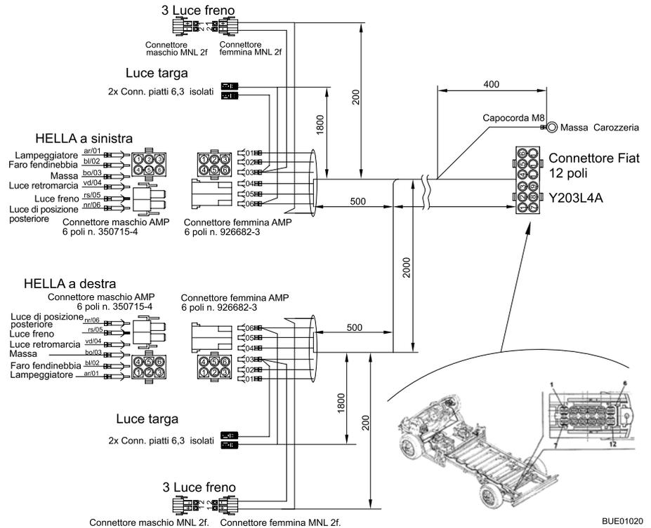
Fig. 132 Schema elettrico esterno
