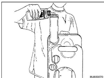
Fig. 188 Rifornimento di liquido sanitario
