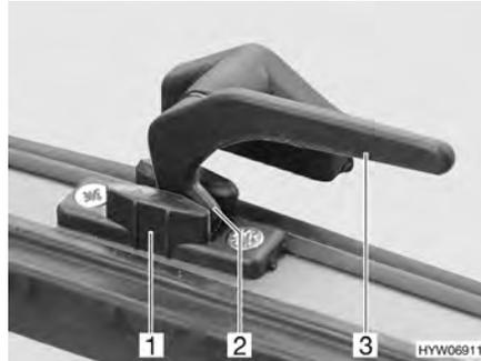
Fig. 70 Leva di serraggio senza bottone di sicurezza in posizione "Aerazione continua"
