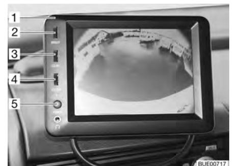
Fig. 12 Display LCD per telecamera retromarcia
