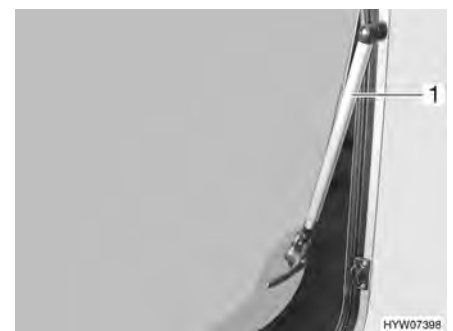
Billede 64 Ventilationsrude med automatiske udskydere
