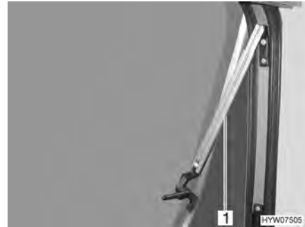
Billede 58 Ventilationsrude med automatiske udskydere
