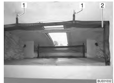
Bild 101 Höjbar säng med uppspänt skyddsnet
