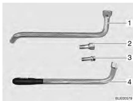
Bild 262 Hjulbultar med fordonsverktyg
