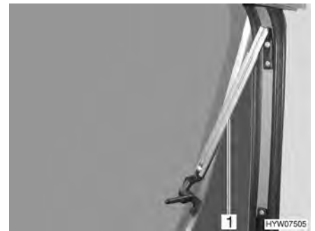
Bild 58 Överkantshängt fönster med automatik-spärr
