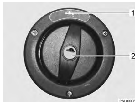
Bild 202 Lock för påfyllningsöppningen för dricksvatten (alternative)
