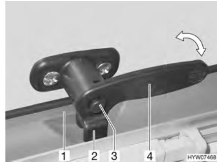
Bild 60 Låsarm med låsknapp i läget "stängd"
