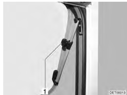
Bild 55 Överkantshängt fönster med vridspärrar, öppet
