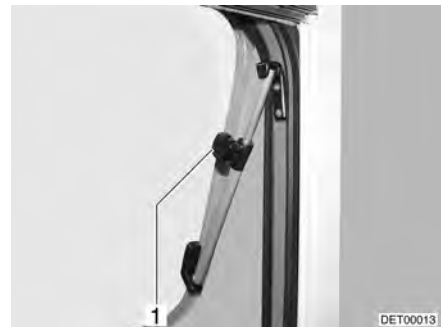
Bild 79 Taklucka med vridspärrar, öppen
