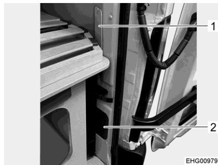
Afb. 138 Toegang tot de bevestiging van de achterlichtenheid (Delfin C)
