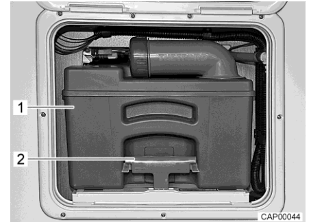
Fig. 79 Depósito de aguas fecales
