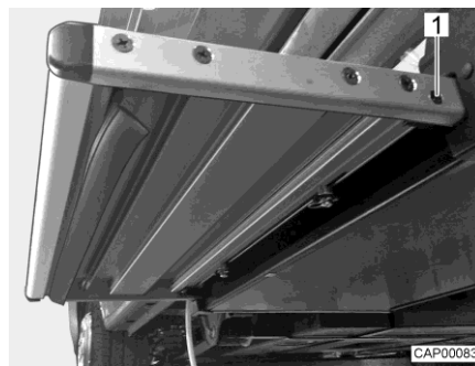
Fig. 80 Tope (escalón de entrada)
