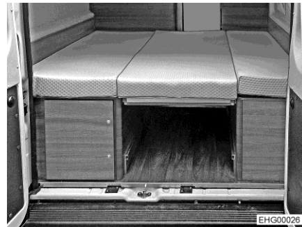
Kuva 41 Poikittaistakasänky järjestelyn jälkeen (3 tyynyn versio)
