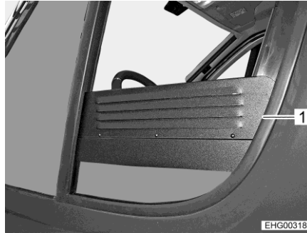
Kuva 53 Pakkotuuletusritilä (sivuikkuna auki)
