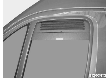
Kuva 54 Pakkotuuletusritilä (sivuikkuna kiinni)
