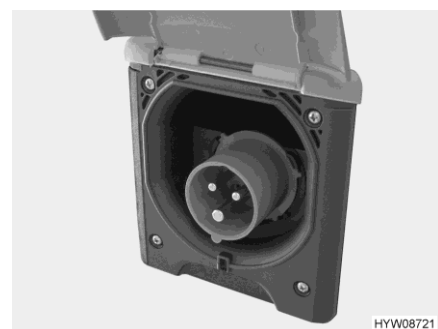
Kuva 72 230 V:n liitântä ajoneuvolla (CEE-pistorasia)
