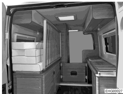
Kuva 48 Kuljetusasento (taitettava sängyn ritilä)
