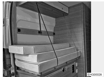
Kuva 49 Kuljetusasento (irrotettava sängyn ritilä)
