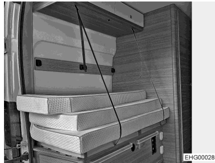
Fig. 41 Transport position (Campeo C 640)
