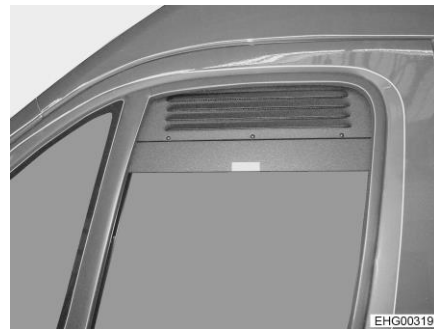
Bild 54 Zwangsbelüftungsgitter (Seitenfenster geschlossen)
