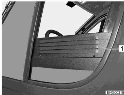
Bild 53 Zwangsbelüftungsgitter (Seitenfenster geöffnet)
