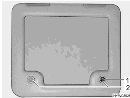
Bild 107 Klappe für den Fäkalientank
