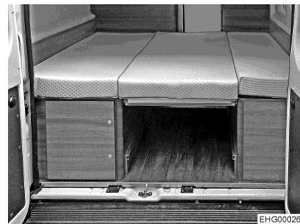
Bild 41 Querheckbett nach dem Umbau (Variante mit 3 Längspolstern)
