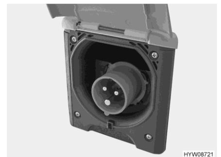
Bild 72 230-V-Anschluss am Fahrzeug (CEE-Steckdose)
