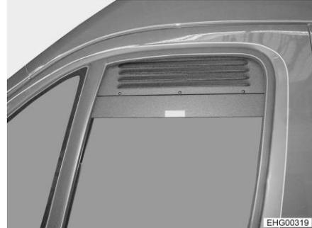
Bild 54 Zwangsbelüftungsgitter (Seitenfenster geschlossen)
