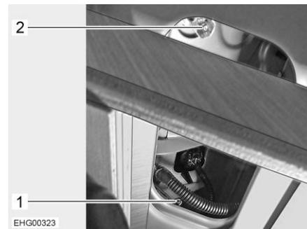
Bild 110 Befestigung der Heckleuchteneinheit
