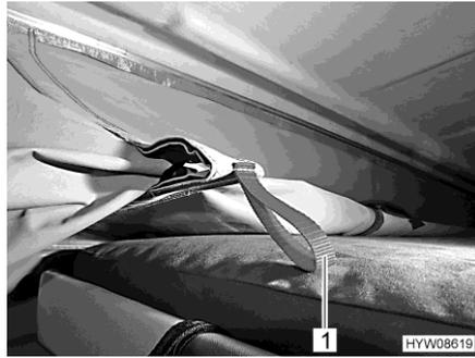
Bild 61 Einzugsvorrichtung
