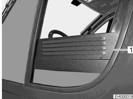
Bild 53 Zwangsbelüftungsgitter (Seitenfenster geöffnet)
