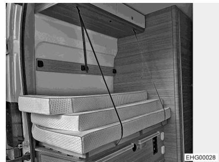
Bild 49 Transportstellung (herausnehmbarer Bettrost)
