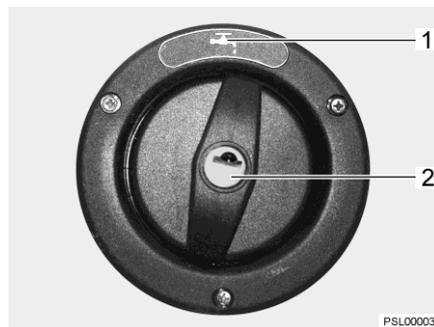
Bild 93 Verschlussdeckel für Trinkwasser-Einfüllstutzen
