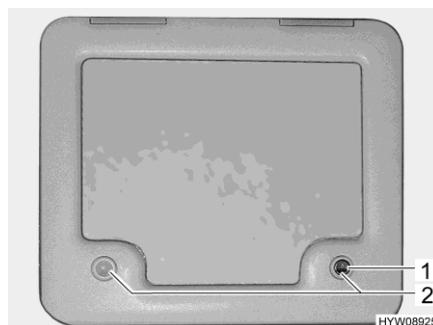
Bild 105 Klappe für den Fäkalientank
