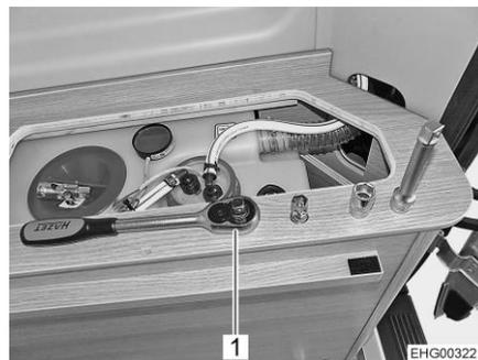
Bild 109 Zugang zur Befestigung der Heckleuchteneinheit
