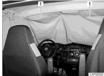
Bild 17 Fahrerhausverdunklung an Frontscheibe
