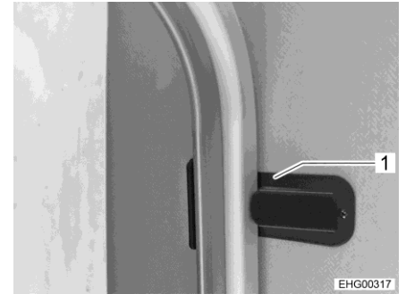
Bild 37 Fällbar sängbotten, hållare
