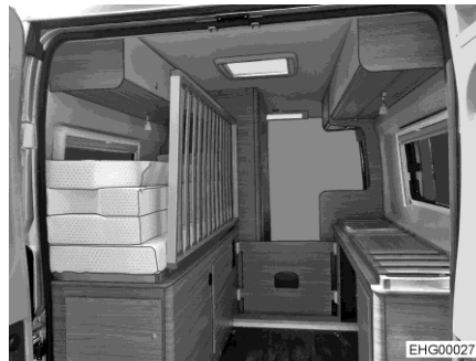
Bild 38 Transportläge (fällbar sängbotten)
