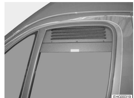
Bild 47 Ventilationsgaller (sidofönster stängt)
