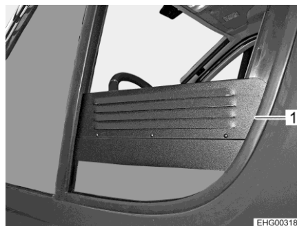
Bild 46 Ventilationsgaller (sidofönster öppet)
