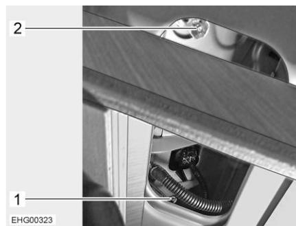
Bild 102 Befestigung der Heckleuchteneinheit
