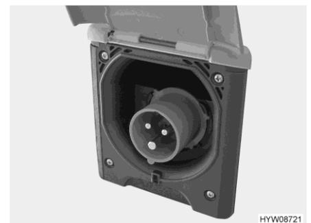
Bild 65 230-V-Anschluss am Fahrzeug (CEE-Steckdose)
