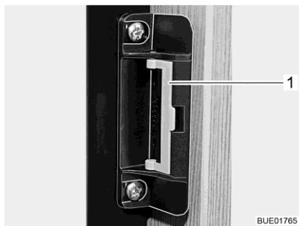
Bild 81 Verschlusseinrichtung in Normalstellung
