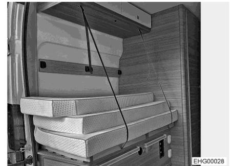
Bild 39 Transportstellung (herausnehmbarer Bettrost)
