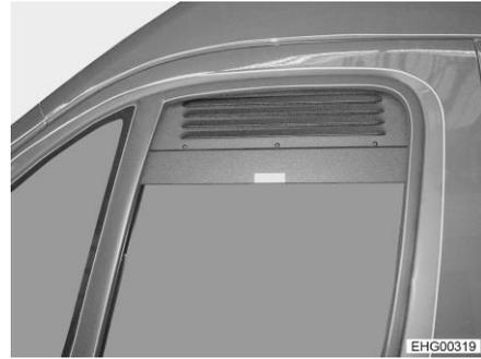
Bild 47 Zwangsbelüftungsgitter (Seitenfenster geschlossen)
