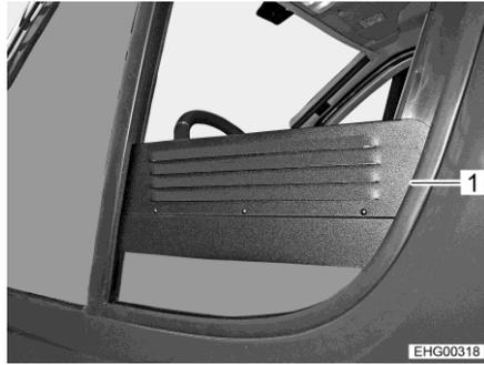
Bild 46 Zwangsbelüftungsgitter (Seitenfenster geöffnet)
