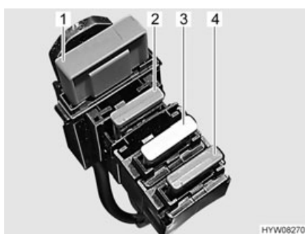
Kuva 46 Sulakkeet asunto-osan akun luona
