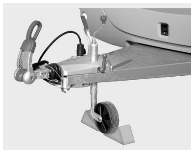
Fig. 157: Asegurar la rueda de apoyo
