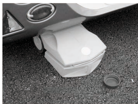
Fig. 101: Depósito de aguas residuales sobre ruedas
