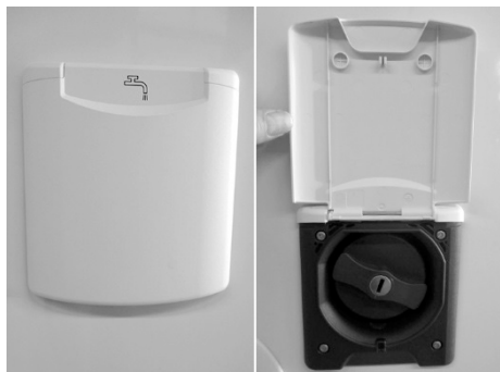
Fig. 96: Tubo de carga de agua limpia
