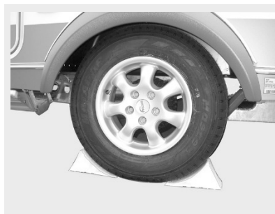
Fig. 158: Asegurar el vehículo
