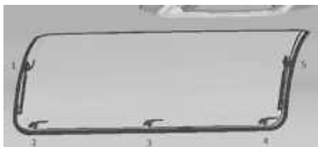
Fig. 37: Vista interior de la ventana cóncava con cinco palancas giratorias
