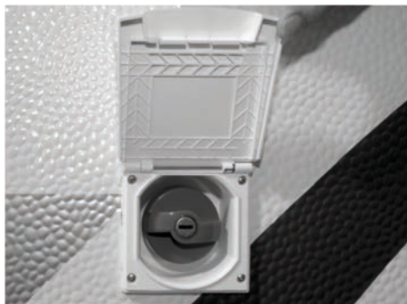
Fig. 87: Tubo de carga de agua limpia
