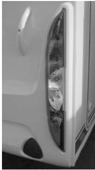
Fig. 166: Fijar la iluminación de popa.
