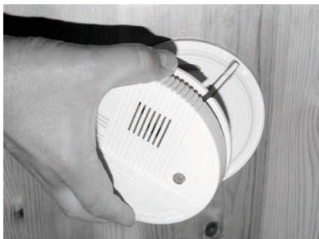
Fig. 110: Retirar la carcasa
