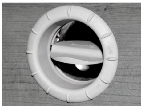
Fig. 128: Salida de aire caliente, abierta
