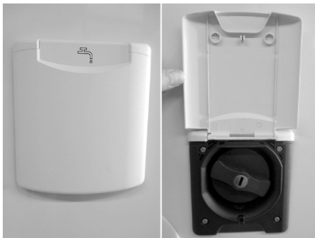
Fig. 32: Tubo de carga de agua limpia
