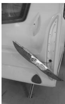
Fig. 163: Soltar la lámpara
