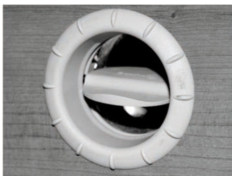
Fig. 84: Salida de aire caliente, abierta
