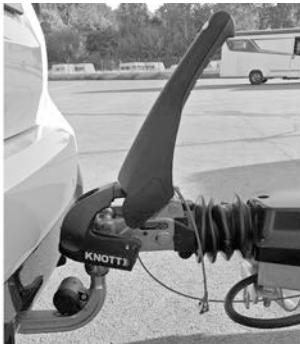
Afb. 13: Trekkogelkoppeling geopend, stabilisatie gedeactiveerd
