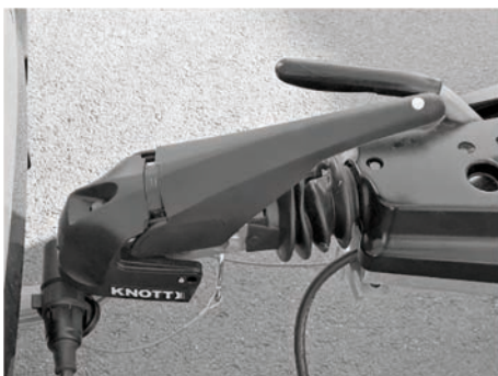
Afb. 10: Trekkogelkoppeling gesloten, stabilisatie geactiveerd
