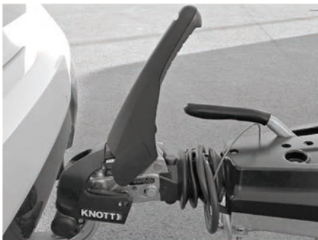
Afb. 9: Trekkogelkoppeling gesloten, stabilisatie gedeactiveerd
