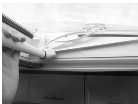
Afb. 119: Dakluik 400x400 mm / VisionStar 700x500 mm bedienen
