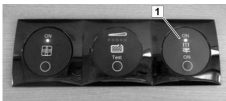
Afb. 86: Aan/uit-schakelaar van de vloerverwarming
