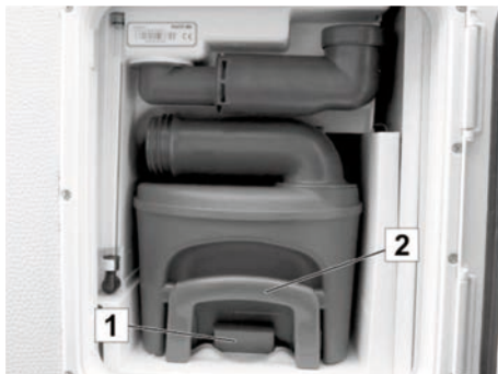
Fig. 142: Toilettank i tømmeskakten
