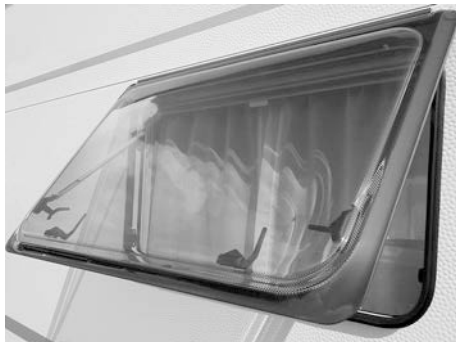
Fig. 33: Hængselvindue med ramme
