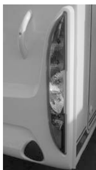
Fig. 166: Montering af hækbelysning.
