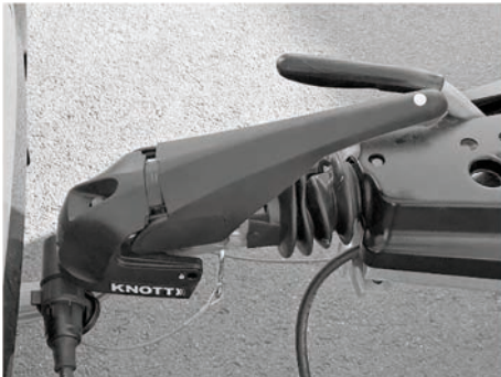
Fig. 10: Kuglekobling lukket, stabilisering aktiveret
