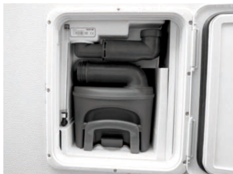
Fig. 53: Toilettank med påfyldningsstuds til skyllevand
