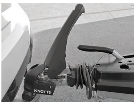
Fig. 9: Kuglekobling lukket, stabilisering deaktiveret
