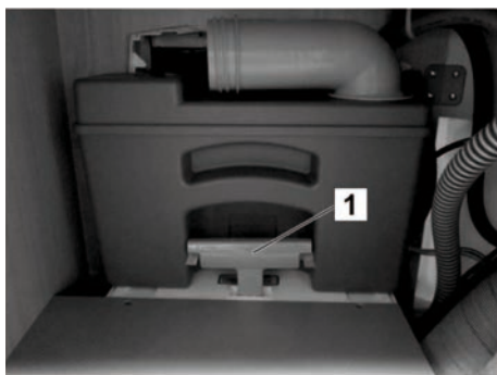
Fig. 145: Toilettank i tømmeskakten
