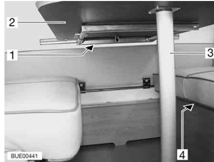
Fig. 102 Trasformazione in struttura di supporto letto
