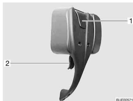
Fig. 43 Serratura della porta di ingresso, lato interno, bloccata
