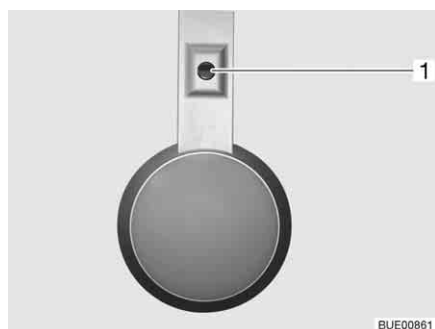
Fig. 60 Lampada, interruttore luci direttamente sulla lampada
