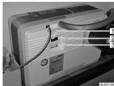
Fig. 135 Campo di collegamento pila a combustibile
