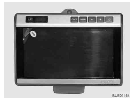
Fig. 24 Display LCD per telecamera retromarcia (Waeco)
