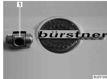
Fig. 22 Telecamera retromarcia con luce a infrarossi (Waeco)
