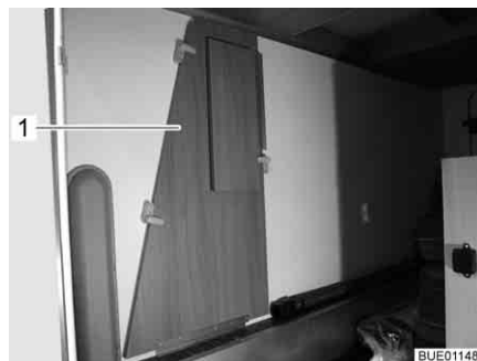
Fig. 17 Allargamento letto nel garage di coda
