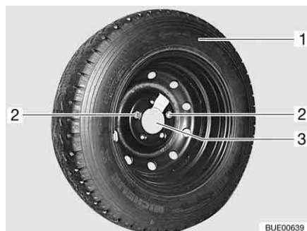
Fig. 257 Supporto per la ruota di scorta nel garage di coda
