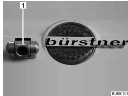
Fig. 22 Caméra de marche arrière avec éclairage à infrarouge (Waeco)
