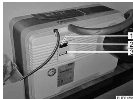
Fig. 135 Champ de raccordement de la pile à combustible
