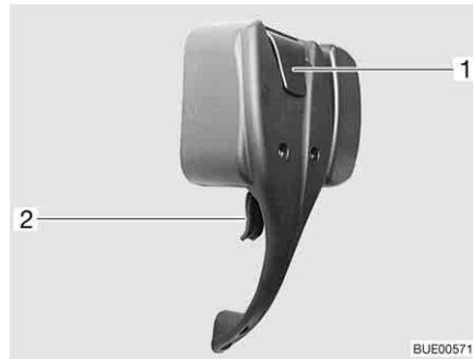
Fig. 43 Serrure de la porte cellule, à l'intérieur, verrouillée
