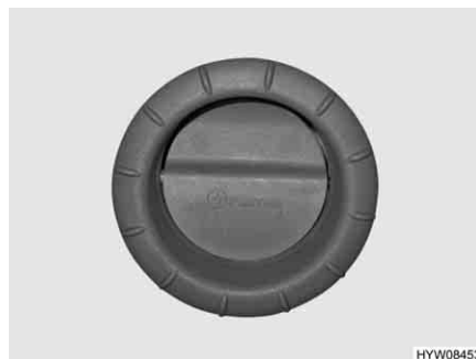
Fig. 158 Buse de sortie d'air
