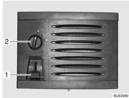
Fig. 168 Boutons de commande d'échangeur de chaleur supplémentaire
