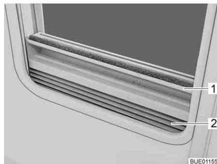
Fig. 46 Dispositif occultant plissé
