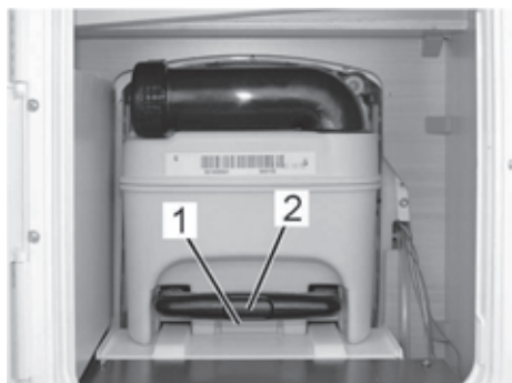
Fig. 133: Serbatoio acque nere nel vano WC
