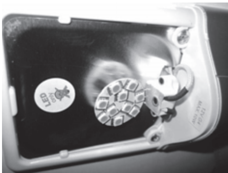
Fig. 151: Sostituire i corpi illuminanti a LED
