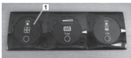
Fig. 87: Interruttore ON/OFF per la preparazione di acqua calda sanitaria
