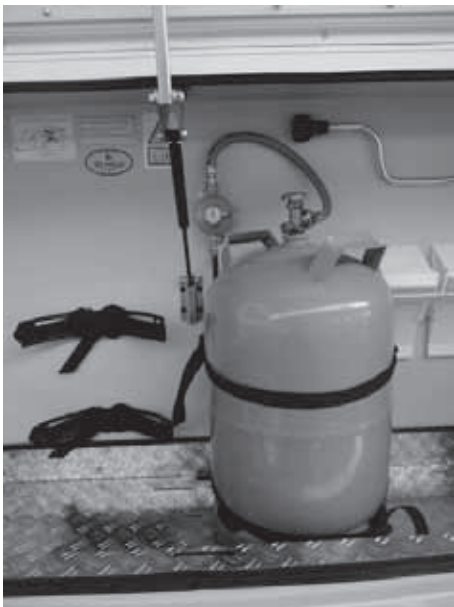
Fig. 98: Montaggio a parete della bombola di gas
