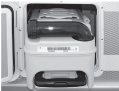
Fig. 43: Serbatoio acque nere
