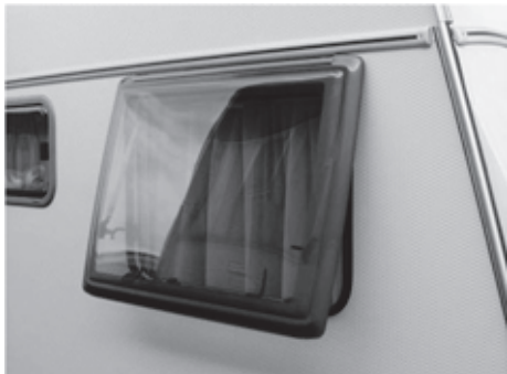
Fig. 24: Vindu som åpnes utover, med ramme
