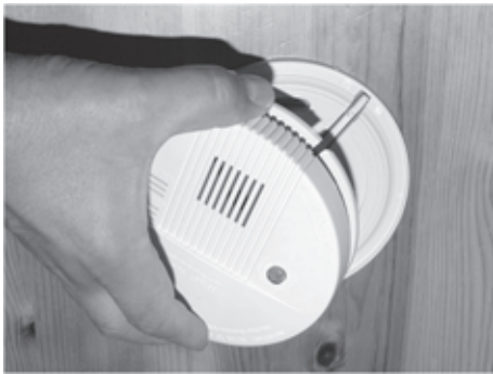
Fig. 100: Ta av huset
