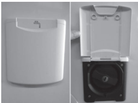
Fig. 89: Påfyllingsstuss for ferskvann
