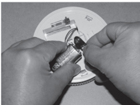
Fig. 101: Skift ut batteriet
