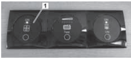
Fig. 122: På/av-bryter for varmtvannsberedningen
