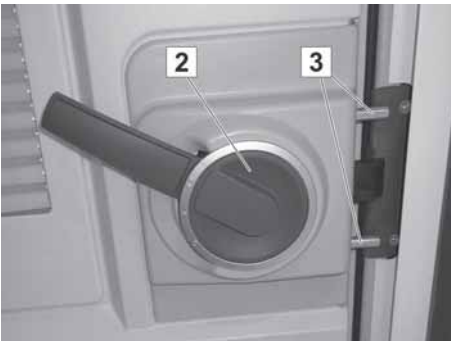
Abb. 15: Tür geschlossen und gesichert
