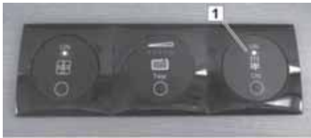
Abb. 75: Ein-/Aus-Schalter der Fußbodentemperierung
