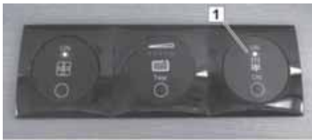
Abb. 111: Ein-/Aus-Schalter der Fußbodentemperierung
