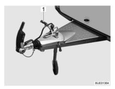
Fig. 22 Handbrake
