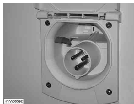
Billede 125 230 V-tilslutning på køretøjet
