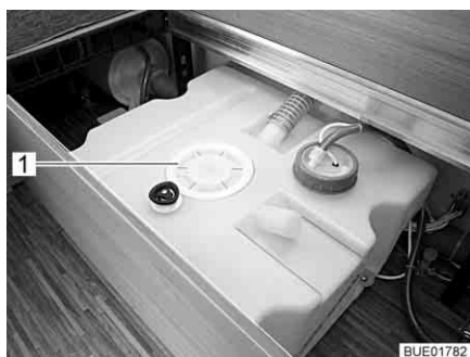
Billede 207 Rengøringsåbning på vandtank (eksempel)
