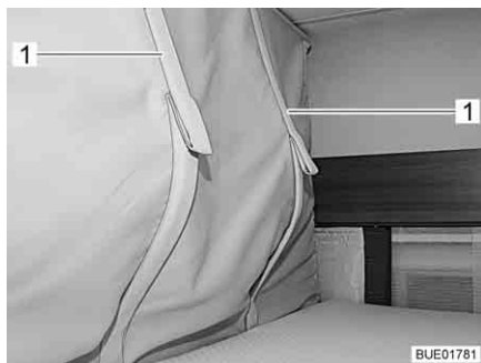
Billede 84 Hjælpeløkker til sammenklapning
