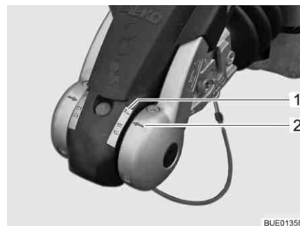
Billede 6 Kontrol "AKS lukket"
