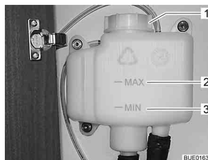
Billede 213 Udligningsbeholder uden blænde
