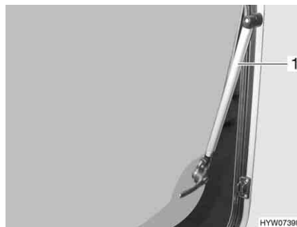
Billede 59 Ventilationsrude med automatiske udskydere
