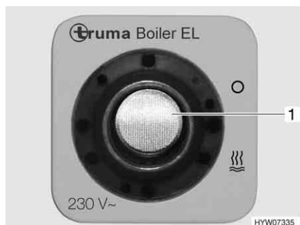
Billede 157 Kipafbrydere til Truma-vandvarmeren (230 V-eldrift)
