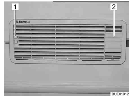
Billede 174 Køleskabets ventilationsgitter (med indsats til udstødning)
