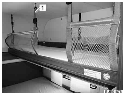
Billede 90 Skabsklapseng med opspændt sikkerhedsnet
