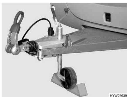
Billede 230 Sikring af støttehjulet
