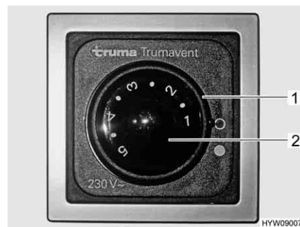
Billede 145 Betjeningskontakt for cirkulationsluftblæseren (alternativ)
