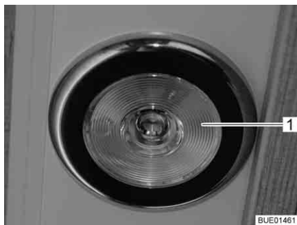
Billede 49 Indbygget lampe, lyskontakt i lampen
