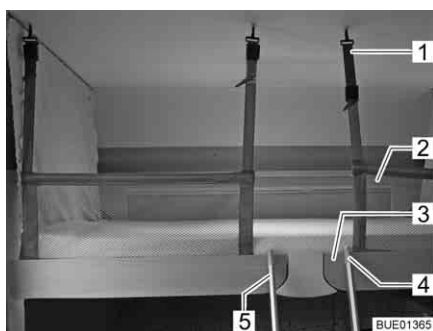
Billede 85 Hejseseng med opspændt sikkerhedsnet
