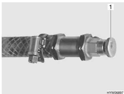
Billede 214 Udluftningsventil varmtvandsvarmeovn
