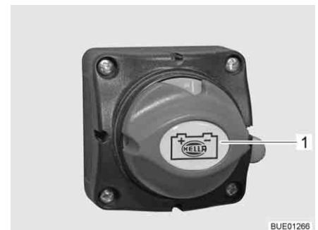
Bild 119 Batterie-Hauptschalter, Stellung "ON"
