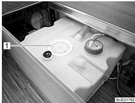
Bild 207 Reinigungsoffnung Wassertank (Beispiel)
