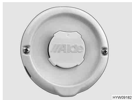
Bild 149 Wandkamin der Warmwasser-Heizung
