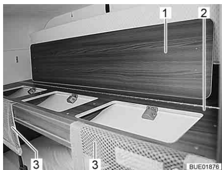
Bild 88 Sicherungsnetze und Einlegeplatte
