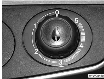
Bild 143 Drehregler an der Warmluft-Heizung
