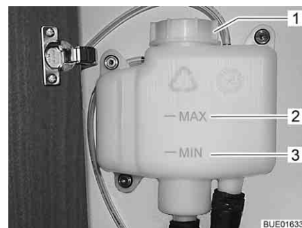
Fig. 213 Vaso d'espansione senza diaframma
