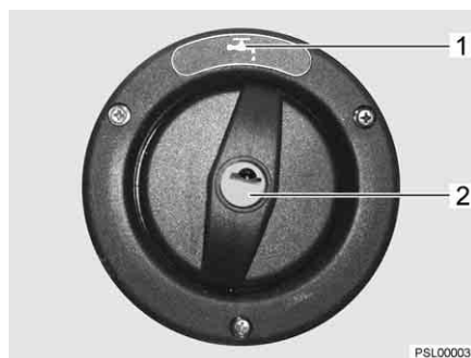
Fig. 38 Coperchio per bocchettone di riempimento dell'acqua potabile
