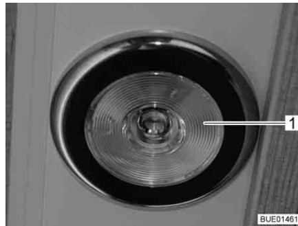
Fig. 49 Lampada a incasso, interruttore luce nella lampada
