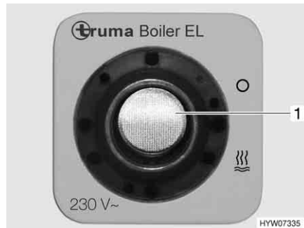
Fig. 157 Interruttore a levetta per boiler Truma (funzionamento elettrico a 230 V)
