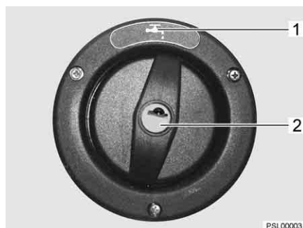
Fig. 188 Bocchettone di riempimento dell'acqua potabile
