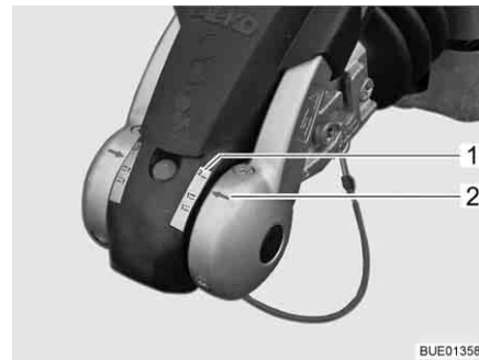
Fig. 6 Controllo "AKS chiuso"
