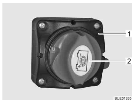
Fig. 118 Interruttore principale batteria, posizione "OFF"
