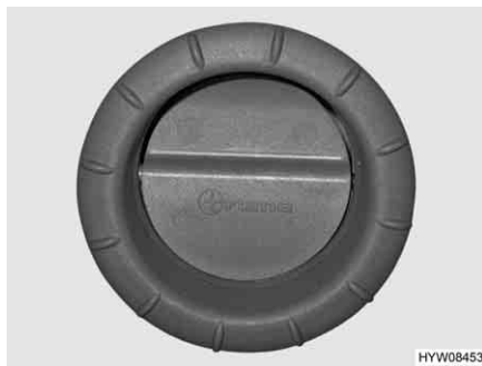
Fig. 138 Bocchetta di uscita dell'aria del riscaldamento ad aria calda
