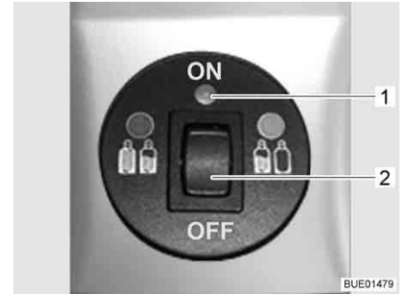
Afb. 112 Bedieningspaneel met afstandsindicatie
