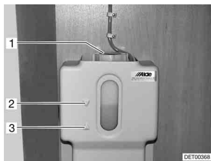
Afb. 212 Buffertank met afscherming
