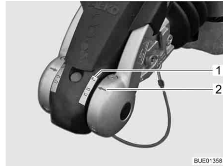
Billede 7 Kontrol "AKS lukket"
