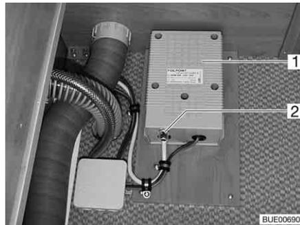
Fig. 143 Transformador para calentamiento eléctrico del piso
