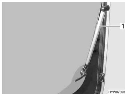
Fig. 64 Ventana abatible con soporte automático
