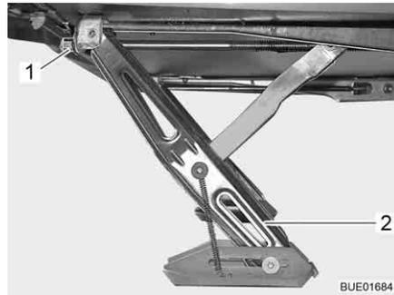
Fig. 24 Apoyo a manivela con placa base (bajado a manivela)
