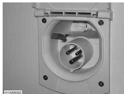
Fig. 121 Conexión de 230 V en el vehículo
