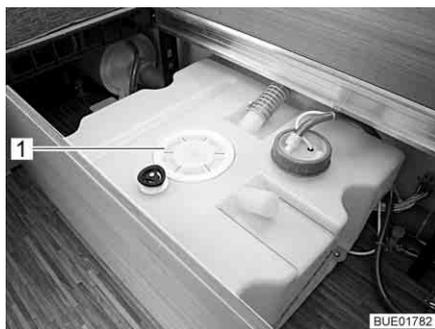
Fig. 194 Orificio de limpieza del depósito de agua
