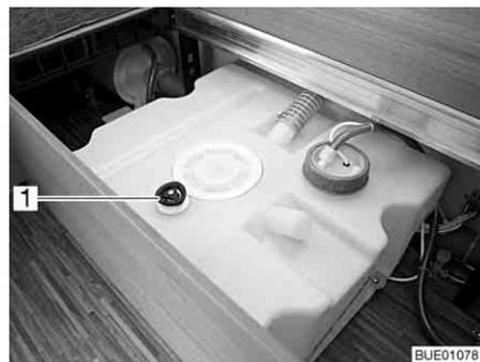
Fig. 179 Depósito de agua
