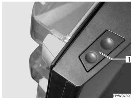
Fig. 169 Botón de desbloqueo de la puerta del frigorífico (Dometic de la serie 8)
