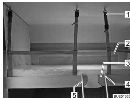
Bild 89 Hubbett mit aufgespanntem Sicherungsnetz
