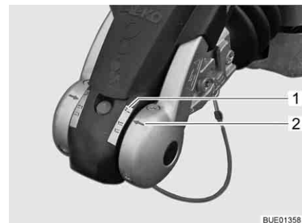
Bild 7 Kontrolle "AKS geschlossen"
