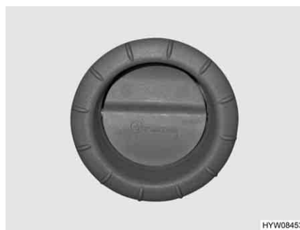
Bild 134 Luftaustrittsdüse der Warmluftheizung
