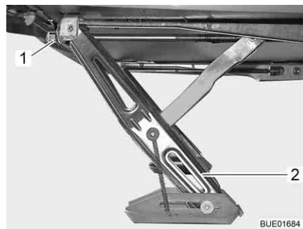
Bild 24 Kurbelstütze mit Fußplatte (heruntergekurbelt)
