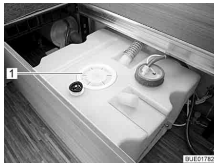
Bild 194 Rengöringsöppning på vattentanken
