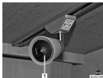
Afb. 218 Zuignap voor het vervangen van lampen
