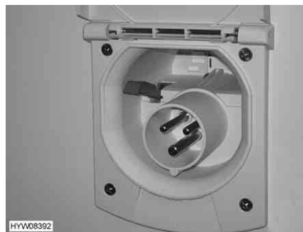
Afb. 126 230-V-aansluiting op het voertuig
