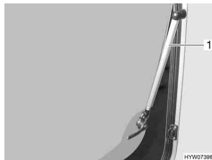
Afb. 64 Uitzetbaar raam met automatische uitzetters
