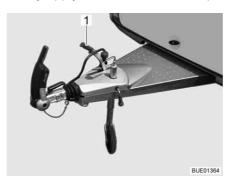
Fig. 18 Handbrake
