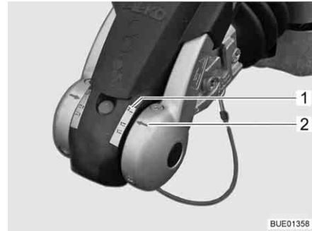
Billede 4 Kontrol "AKS lukket"
