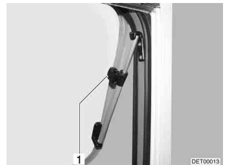
Billede 53 Ventilationsrude med drejueskydere, åben
