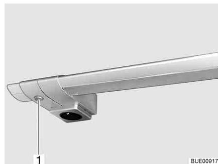
Afb. 42 Binnenverlichting, lichtschakelaar direct bij de lamp
