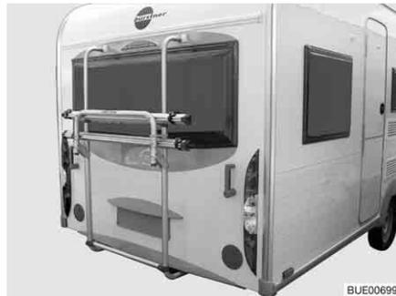
Bild 10 Fahrradträger an Heckwand
