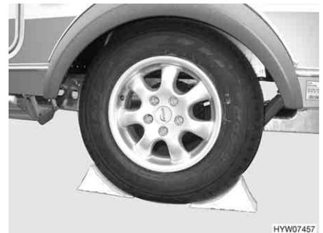
Bild 231 Fahrzeug sichern
