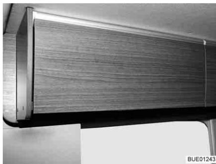
Bild 36 Möbelklappen mit Druckentriegelung (Beispiel)
