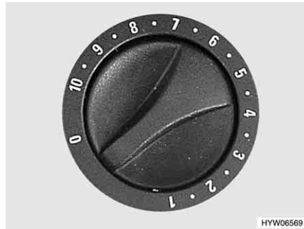
Bild 108 Drehregler an der Heizung
