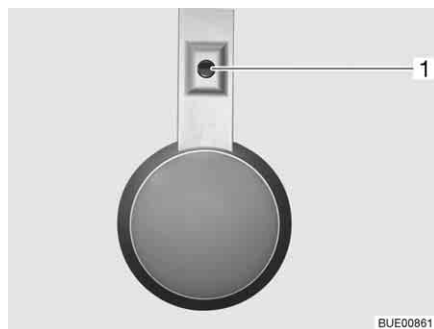
Bild 39 Toilettenraumbeleuchtung, Lichtschalter direkt an der Leuchte
