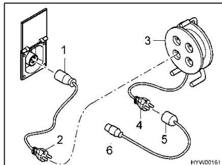
Fig. 94 Posibilidades de conexión de 230 V
