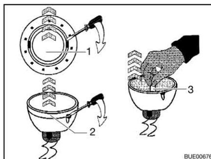
Fig. 204 Cambiar la bombilla halógena
