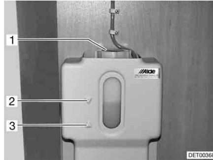
Fig. 195 Recipiente de compensación para la calefacción de agua caliente
