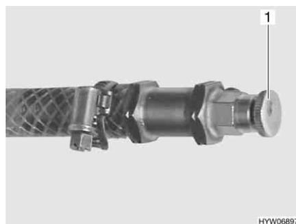
Fig. 196 Válvula de purga de la calefacción de agua caliente
