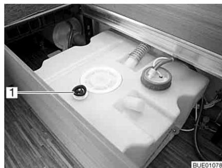
Fig. 149 Depósito de agua
