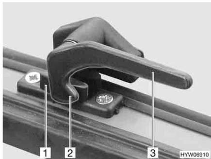
Fig. 48 Palanca de bloqueo en la posición de "cerrado"
