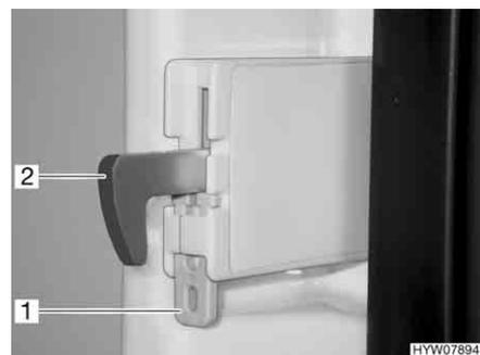
Fig. 143 Fijación del gancho de bloqueo
