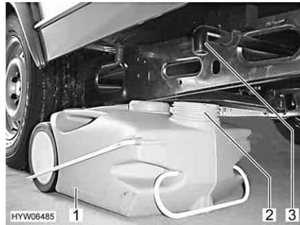
Fig. 21 Depósito de aguas residuales, con ruedas
