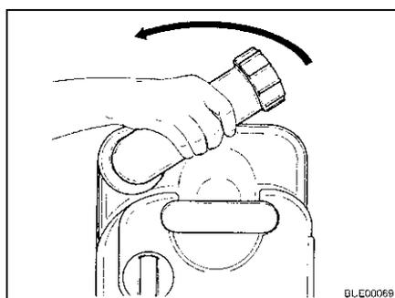
Fig. 156 Girar el tubo de vaciado
