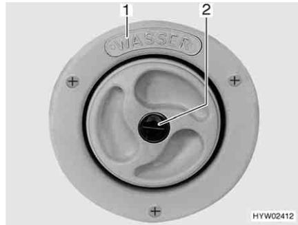
Fig. 147 Tubo de llenado de agua potable
