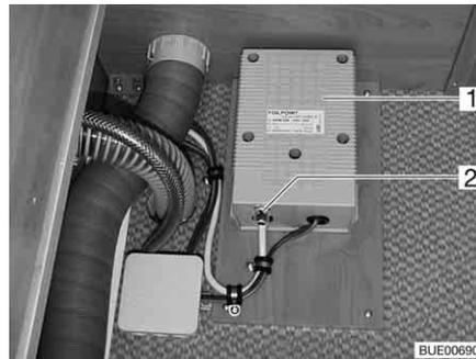
Fig. 117 Transformador para calentamiento eléctrico del piso
