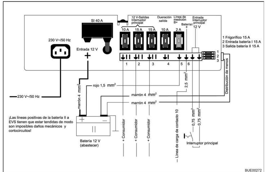
Fig. 93 Esquema de conexión 2
