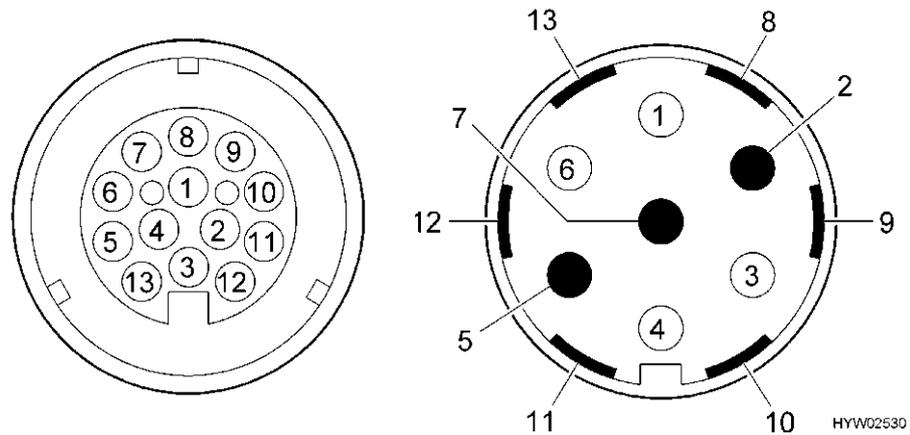
Fig. 100 Figura de contactos del conector de trece polos
